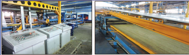
خط إنتاج متواصل للساندوتش پائل بالصوف الصخرى (سقفى) كوريا الجنوبية
